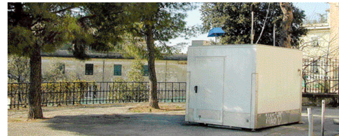
Centralina di rilevamento della qualità dell'aria
